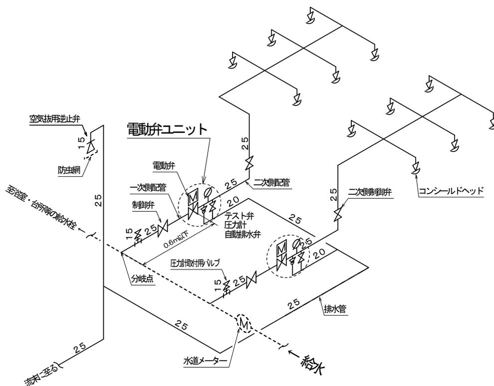
図4-2 配管構成例図 (2系統の場合)
