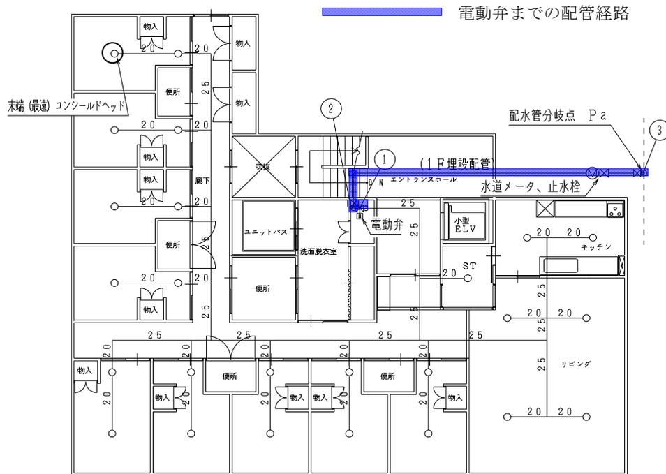
図5-5 電動弁までの配管経路
