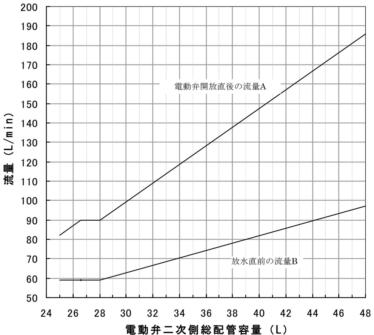
水道用硬質ポリ塩化ビニル管、耐熱性硬質ポリ塩化ビニル管、水道用ステンレス鋼管、水道用架橋ポリエチレン管、水道用ポリブデン管、配管用炭素鋼管を使用する場合の流量A,B
