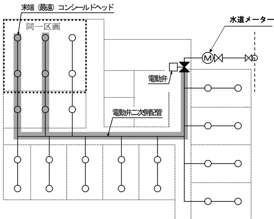
図4-6 同一区画に複数の枝配管のヘッドが設置された場合の例
