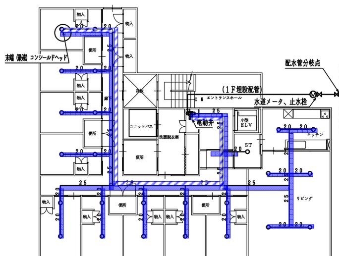
図5-4 配管設計および電動弁二次側配管容量算出部分の例
