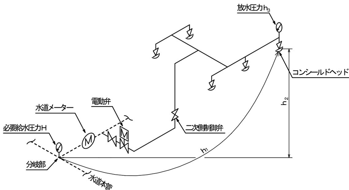
図5-1 必要給水圧力計算概念図
