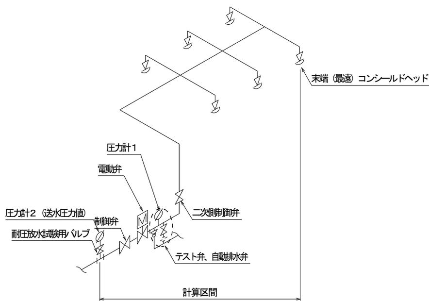
図6-1 放水試験圧力値の計算概念図
