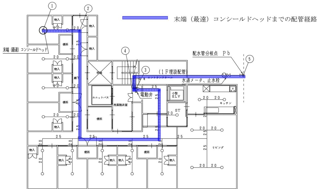
図5-7 末端 (最遠) コンシールドヘッドまでの配管経路
