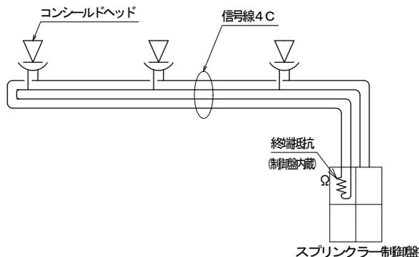
図4-8 コンシールド部配線概念図
