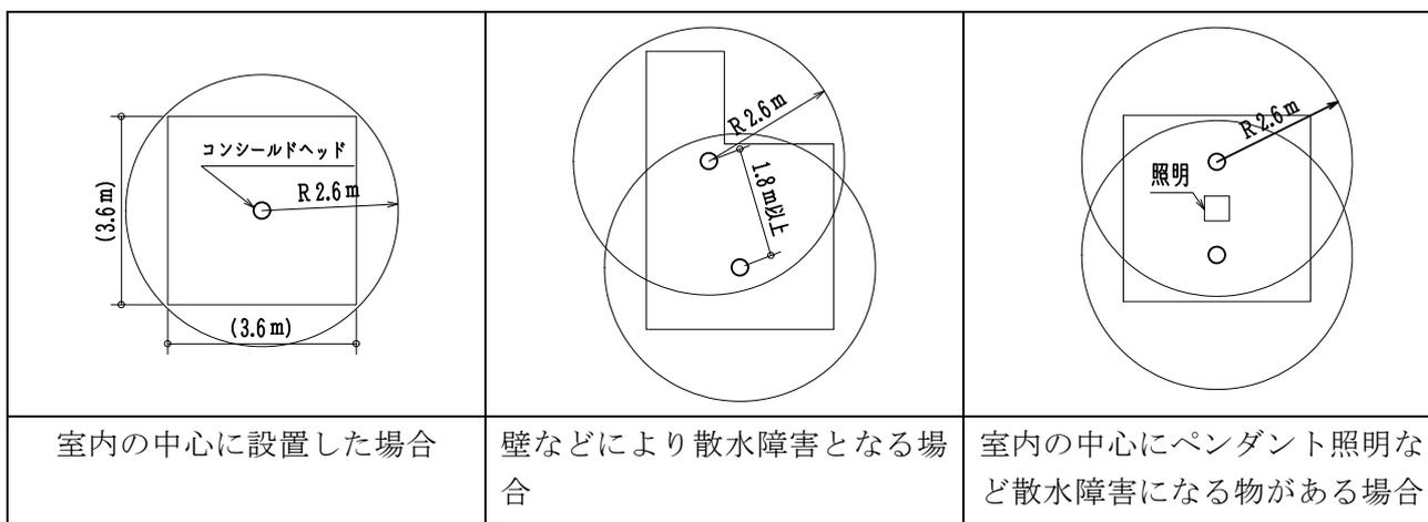
図4-1 コンシールドヘッド配置例
