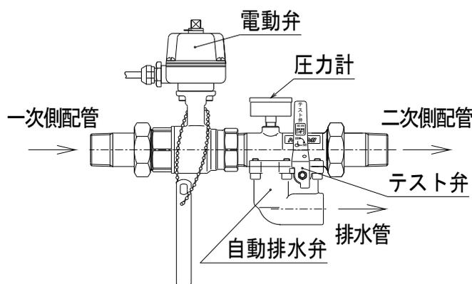
図4-3-1 電動弁ユニットの外観図
