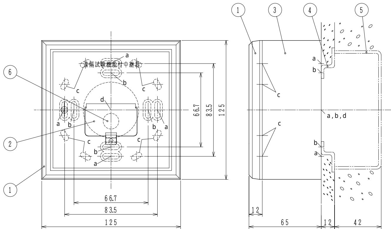
(a, b : 露出ボックス取付穴) 5×15長穴 8ヶ所
