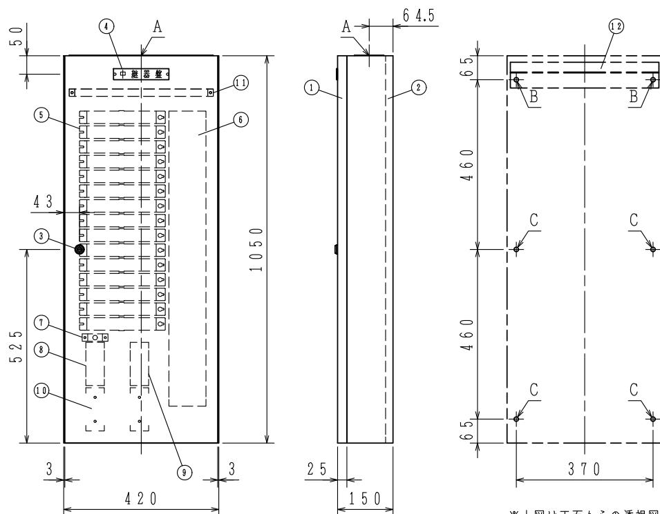
A : 電線引込穴 370×65角穴 (2分割カバープレート付)
