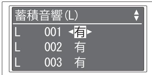
3 「△(上)」「▽(下)」スイッチを押して回線を選択し、「◀(左)」「▶(右)」スイッチを押して、設定項目を選択します。
