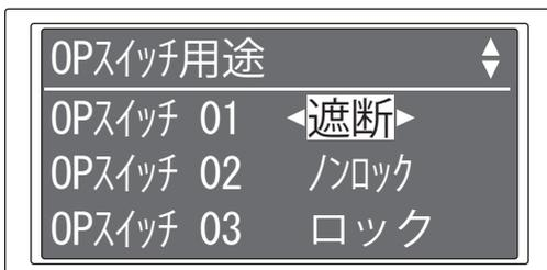
2 「△(上)」 「▽(下)」スイッチを押してOPスイッチを選択し、「◀(左)」 「▶(右)」スイッチで設定項目を選択します。
