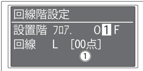
①設置階01Fに対して回線がいくつ設定されているかを点数で表しています。今回の場合[00点]は回線が設定されていない事を表しています。
