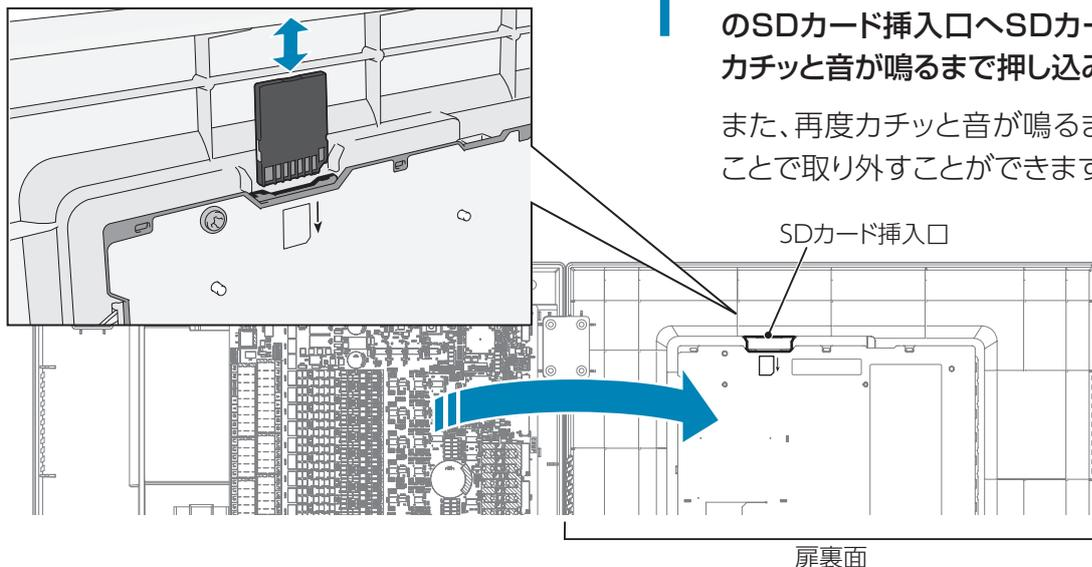
1 本機(扉裏面)に取り付けられた基板上部のSDカード挿入口へSDカードを挿入し、カチッと音が鳴るまで押し込みます。
