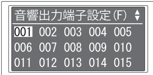
5 [F(PSU・OP)]を選択し、「設定/確認」スイッチを押します。
