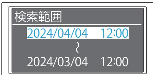
3 「現在日時」～「1か月前の日時」が表示されるので、「設定/確認」スイッチを押します。
