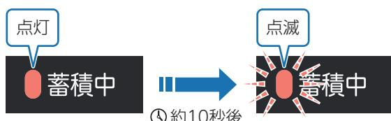
「蓄積中」灯が約10秒間点灯の状態で、感知器が自動的に復旧され、点滅に切り替わります。
