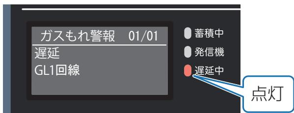
「ピンポン」と音響が鳴り、「遅延中」灯が点灯します。また、ガスもれ検知器が作動した回線が表示されます<sup>\*1</sup>。
