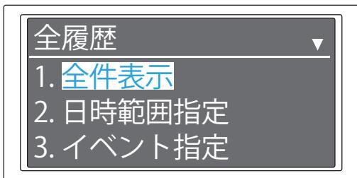
3 [1.全件表示]を選択し、「設定/確認」スイッチを押します。
