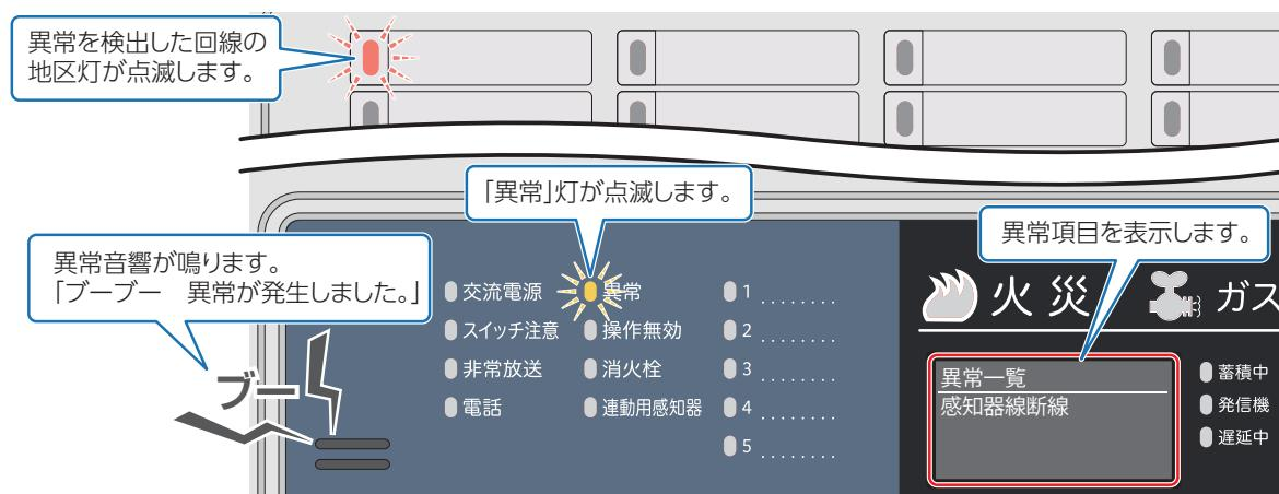
注) LCD画面に異常項目を表示し、異常灯が点滅します。図は、感知器回線で断線が発生した場合の状態を示しています。
