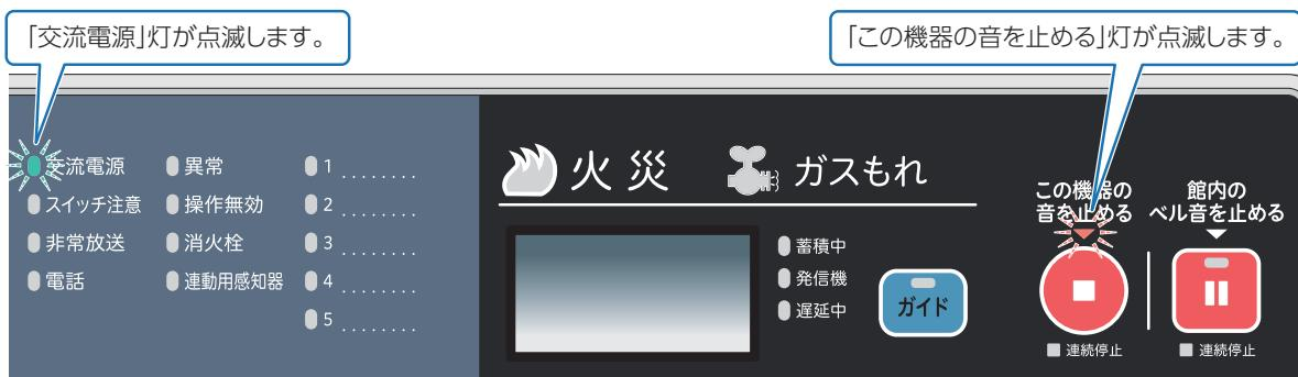
なお、予備電源電圧は徐々に低下しますが、回路電圧の異常を検知する前に復電した場合は、正常な監視状態に戻ります。
