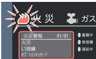
また、火災発生と同時に警備会社、エレベータなどの関連設備、および付属設備(表示機、非常放送、防排煙設備など)に火災信号が移報されます。
