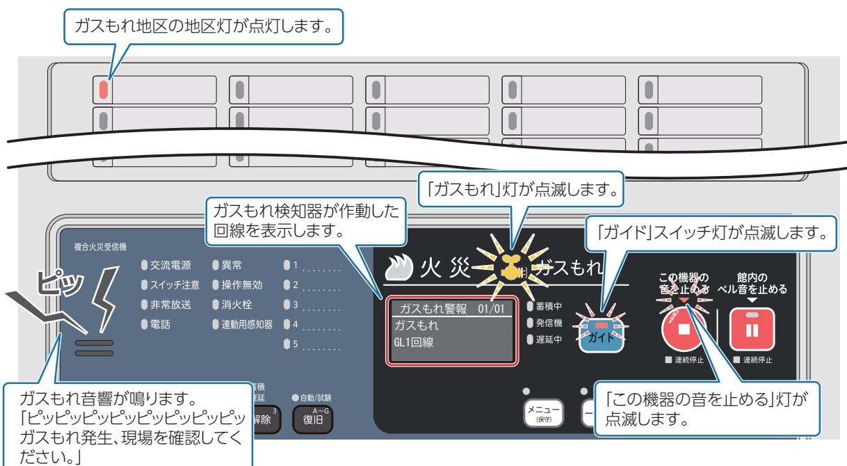
また、ガスもれ発生と同時に警備会社、エレベータなどの関連設備、および付属設備（表示機、防排煙設備など）にガスもれ信号が送信される場合があります。なお、ガスもれ信号の送信先は、本機のデータベースで設定されています。
