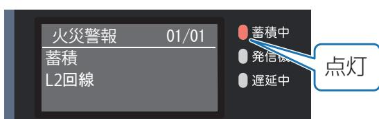
「ピンポーン」と音響が鳴り、「蓄積中」灯が点灯し、LCD画面に[蓄積]の文字と感知器が作動した回線を表示します。<sup>※1</sup>
