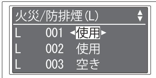
4 「△(上)」 「▽(下)」スイッチを押して回線を選択し、「◀(左)」 「▶(右)」スイッチを押して、設定項目を選択します。
