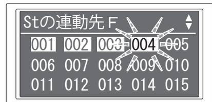
**2** 『3-9 遮断スイッチ設定[10.遮断スイッチ]』(p.53)で、F4 から初期設定の遮断スイッチ(OP4)を解除します。
