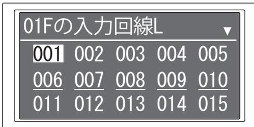
5 「△(上)」「▽(下)」スイッチを押して設定項目を選択し、「設定/確認」スイッチを押します。
