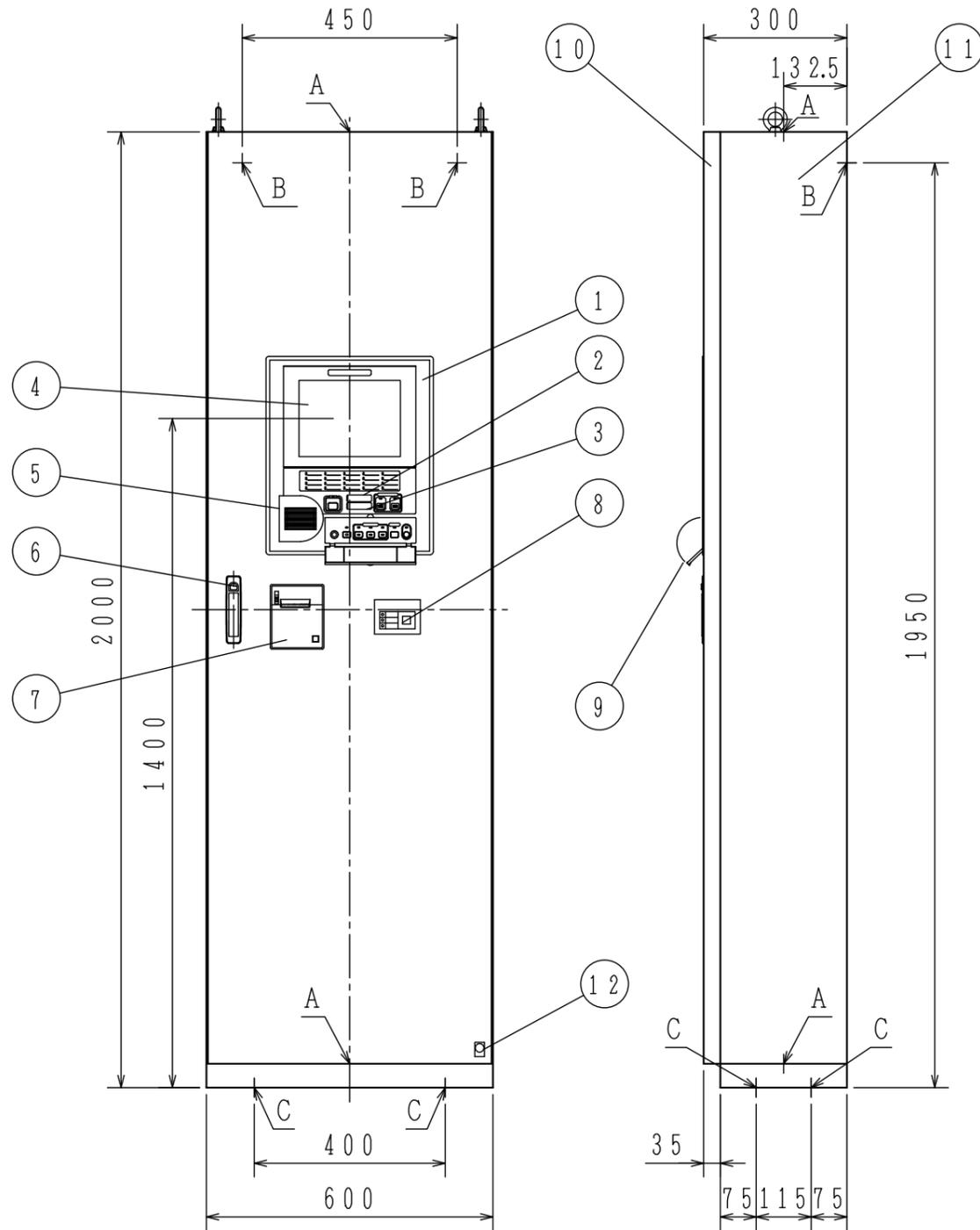
A : 電線引込孔 2-470×135角穴 (2分割カバープレート付)
