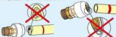
傷ついたパイプ又は継手とパイプの間にゴミがはさまると漏水する
