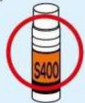
熱膨張パテをポリブテン管に直接被せると、使用条件によって管の性能に影響を及ぼす場合があります。
