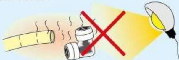
直接日光の当たる所での保管や配管はしないでください。劣化の原因になります。屋外で保管や配管をする際は、適切な遮光処置(遮光カバー、耐候性部材使用等)を必ず行ってください。
