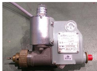
起動弁開放装置の作動状態
