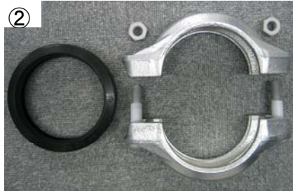
② ナット取り外し(ボルト抜け防止付)
