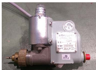
起動弁開放装置の作動状態
