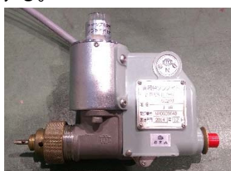
起動弁開放装置の作動状態
