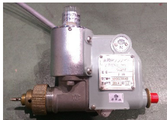
起動弁開放装置の作動状態
