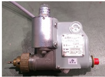
起動弁開放装置の作動状態
