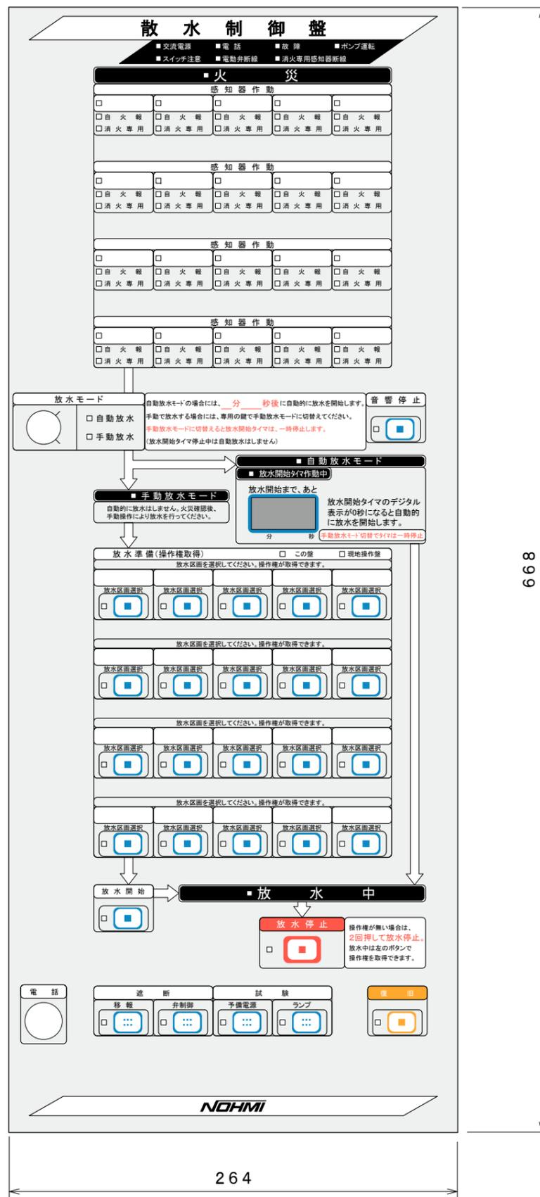
MUWJ011-16~20L型散水制御盤
