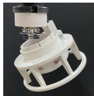
コンシールド部が脱落した場合
