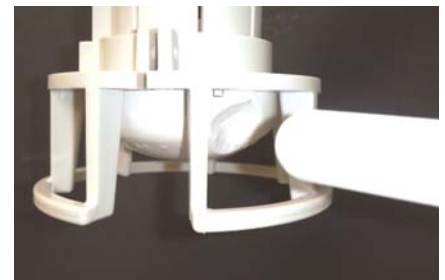
細い棒が当たってコンシールド部が変形
