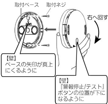
①取り付け面（天井・壁）の充分に強度のある補強材などが通っている場所に取付ネジで取付ベースを固定してください。
