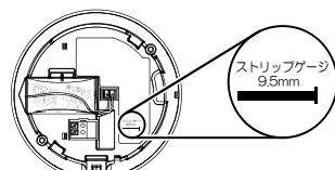
②電線を差込端子に正しく接続してください。
