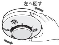
●**まるくいの**の本体が汚れたら、中性洗剤を浸して十分に絞った布で本体の汚れを拭き取ってください。その際、煙流入部に触れないように注意してください。
