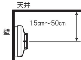
■換気口などの空気吹き出し口から1.5m以上離してください。
