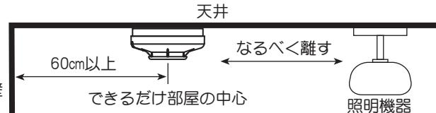
■壁面に取り付けるときは天井面下15cmから50cmまでの範囲で部屋の中心に取り付けてください。警報停止ボタン、および引きひもが下になる方向に取り付けてください。
