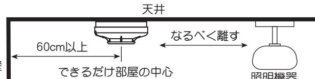
■壁面に取り付けるときは天井面下15cmから50cmまでの範囲で部屋の中心に取り付けてください。
