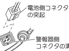
図のように電池側コネクタの突起と警報器側電池コネクタの溝をあわせて、奥までしっかりと接続し電池収納部に電池を納めます。
