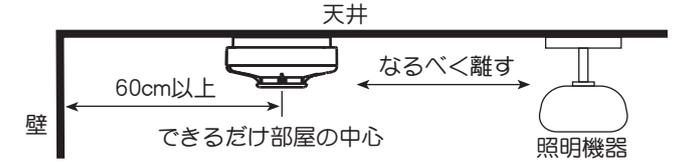
■壁面に取り付けるときは天井面下15cmから50cmまでの範囲で部屋の中心に取り付けてください。警報停止ボタン、および引きひもが下になる方向に取り付けてください。
