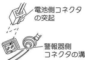
図のように電池側コネクタの突起と警報器側電池コネクタの溝をあわせて、奥までしっかりと接続し電池収納部に電池を納めます。
