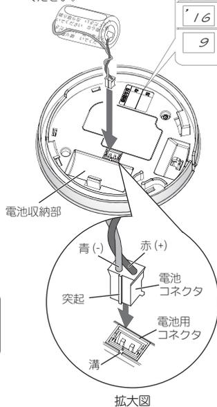
**必ず守る** 専用リチウム電池のコネクタは奥まで差し込む。
