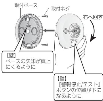
①取り付け面（天井・壁）の充分に強度のある補強材などが通っている場所に取付ネジで取付ベースを固定してください。
