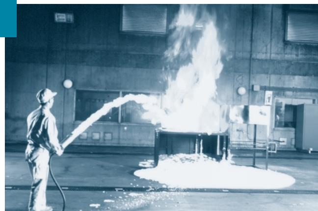
工場火災における工作機械などの火災や可燃性液体による火災に適したパッケージ型泡消火装置として開発された「MIDEX」は1人でも容易に操作が可能であり、強力な消火能力を持つ中膨張泡と遠くまで放射できる低膨張泡の切替放射により、迅速かつ効果的な消火活動ができます。
