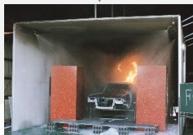
自動車塗装ブース 火災実験
