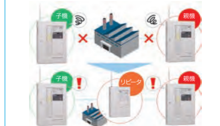
親機-子機間、子機-子機間いずれも中継が可能です。子機もリピータと同様に、電波を中継する機能を持ちます。
