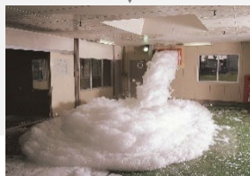
高発泡消火実験
