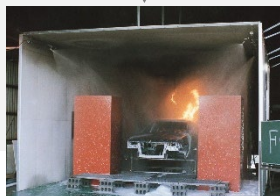
自動車塗装ブース 火災実験
