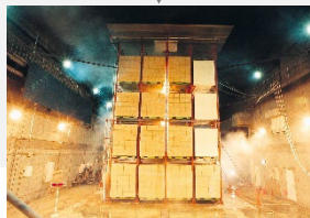
ラック式倉庫 火災実験
