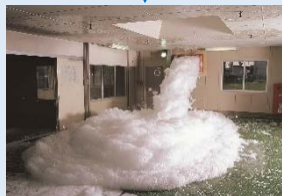
高発泡消火実験
