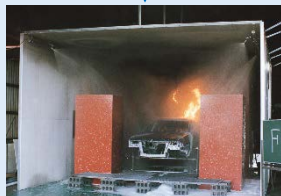
自動車塗装ブース 火災実験
