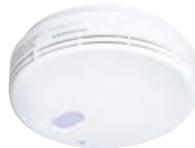
国内初となるCO反応式の無線式連動型住宅用火災警報器。一酸化炭素(CO)を検知すると煙感度を約2倍に切り替え素早く火災を感知。火災を感知すると住戸に設置された全ての警報器が無線で連動し、一斉に火災を警報します。
