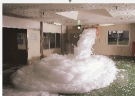
高発泡消火実験
