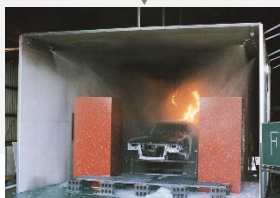
自動車塗装ブース 火災実験
