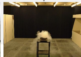
クリーンルームでの 発煙実験
