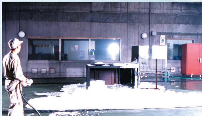
生产设备等发生火灾时, MIDEX III 的中倍数泡沫可附着在器具的表面和侧面, 并且泡沫可以通过缝隙流入到器具的内侧。
